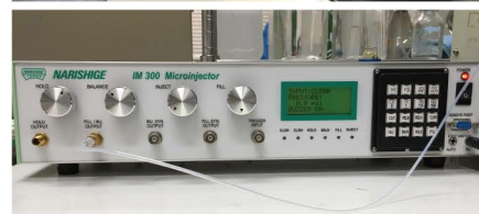
右図：遺伝子ノックアウトアカハライモリ作成に用いるマイクロインジェクター この装置を用いてアカハライモリの卵にRNAとDNA切断酵素溶液の混合液を注入する
